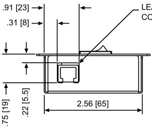
LEAVE CLEARANCE SPACE AS SHOWN FOR CONNECTING PLUG TO REMOTE/LCD PANEL
